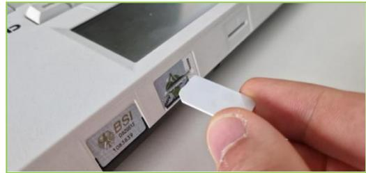
Mit **Hilfe der Trägerkarte** kann die gSMC-KT eingerastet werden (siehe Bild rechts).
