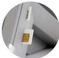
Zwei versiegelbare Plug-Ins zum sicheren Einbringen von SMC-KT und SMC-B
