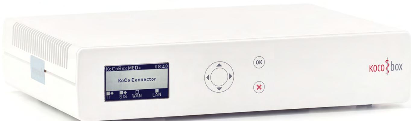
Der Konnektor **koordiniert und verschlüsselt die Kommunikation** zwischen PVS, eGK, eHBA, SMCB und zentraler TI-Plattform. Er stellt damit das **Bindeglied** zwischen diesen Komponenten aufseiten des Leistungserbringers und der TI dar.
