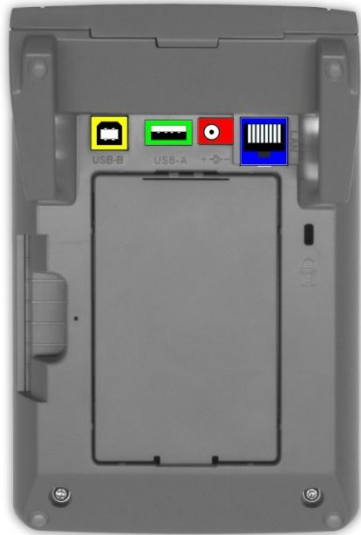
Abbildung 27: Anschlüsse auf der Unterseite des Gerätes
