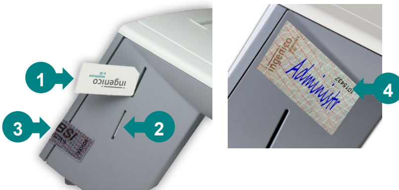
Abbildung 11: Die Kontaktiereinheiten 3 und 4 für die SMC-Karten
