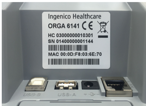
Abbildung 8: Typenschild mit Herstellercode HC 03000000010301
