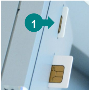
Abbildung 23: Einsetzen der SMC-Karten in die Kontaktiereinheit 3 und 4
