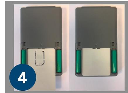
Von der Unterseite des Geräts betrachtet, wird nun die SMC-B mit der Rückseite nach oben in das Batteriefach eingeschoben. Die Kontakte müssen sich dabei im oberen Teil auf der Unterseite befinden.
