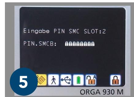
Wurde die Karte korrekt eingelegt, werden Sie nun aufgefordert, Ihre 6-stellige initiale Transport-PIN einzugeben, die Sie auf dem separaten PIN-Brief finden. Nach Eingabe muss eine neue 6-8-stellige SMC-B-PIN vergeben werden. Anschließend können Sie das Batteriefach wieder mit dem Deckel verschließen.
