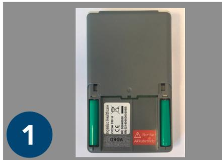
Öffnen Sie zunächst den Batteriefachdeckel des ORGA 930 M online. Legen Sie nun die mitgelieferten Akkus ein. Achten Sie dabei auf die richtige Polarität. Lassen Sie das Batteriefach offen, Sie werden es später noch einmal benötigen.
